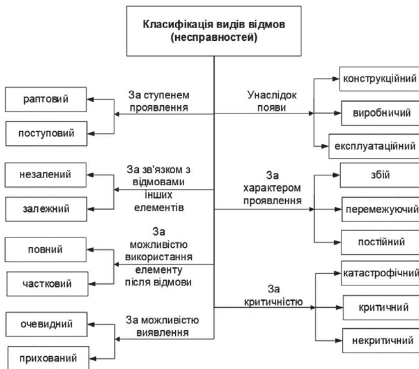
Рис. 3. Класифікація видів відмов (несправностей) електрообладнання судна
