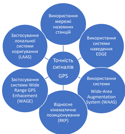
Рис. 2. Методи підвищення точності супутникових сигналів
